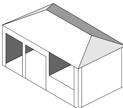
CARATTERISTICHE: generalmente a pianta rettangolare, con tetto a due o quattro falde, contiene le funzioni di stivaggio del fieno e magazzino. Considerata in genere la modesta dimensione di questa tipologia, il lato porticato può essere tamponato.
