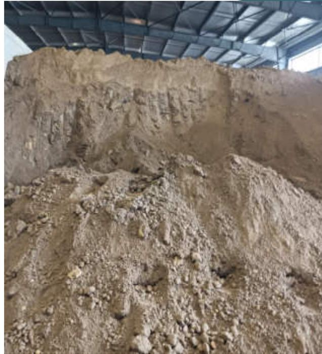
Esempio di rifiuti classificati come pericolosi, preliminarmente stabilizzati attraverso processi di inertizzazione.
