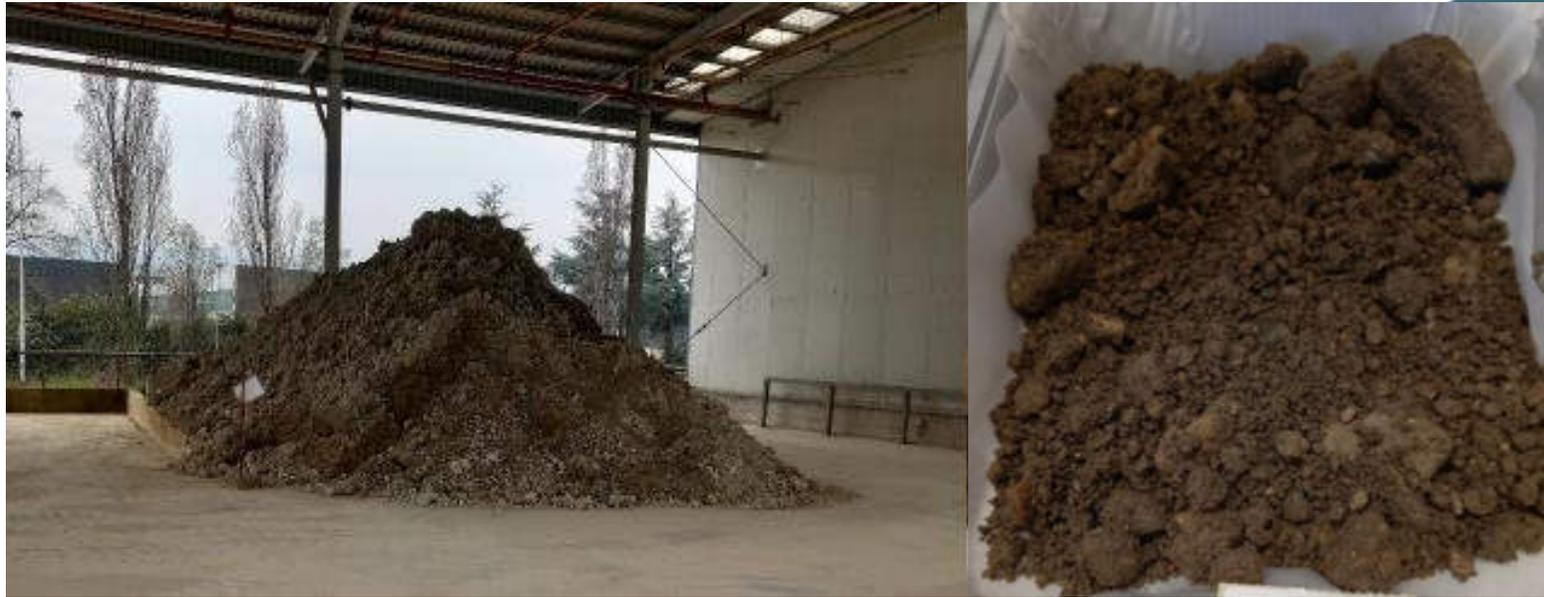
Esempio di terreni generati da interventi di dragaggio fluviale finalizzati alla manutenzione degli argini e delle aste fluviali in genere
